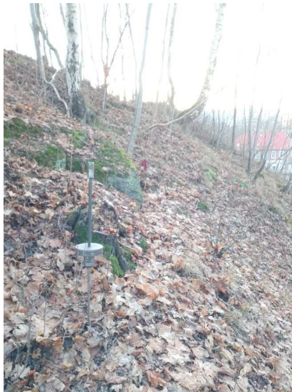
Foto 10: Umístění lehké dynamické penetrace DPL3.
