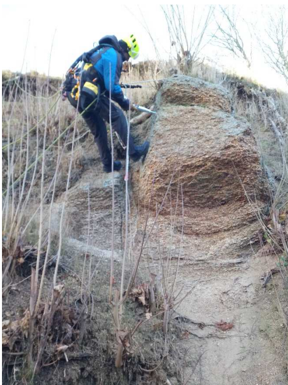
Foto 11: Měření Schmidtovým tvrdoměrem (bod B).
