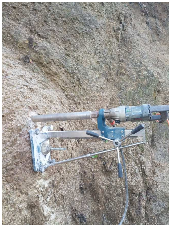
Foto 1: Realizace DIA jádrového vrtu ozn. V1.
